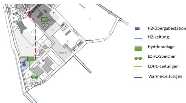
Abbildung 2. Exemplarisches Setup für die bevorzugten Standorte der Hydrieranlage mit Prozessinfrastruktur.
