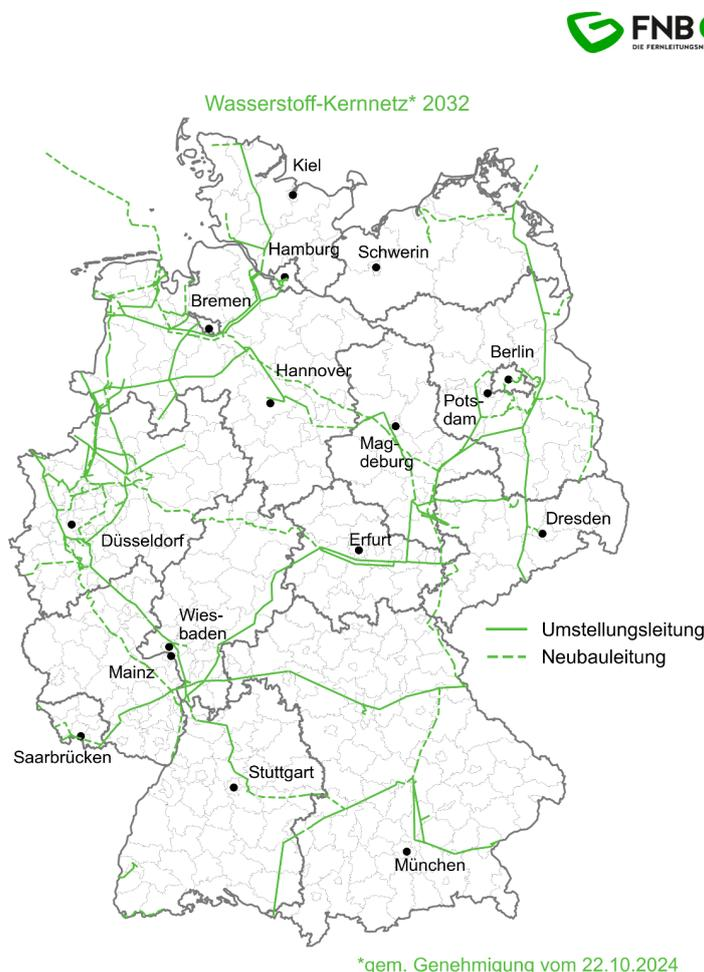
**Abbildung 2.1.** Genehmigtes Wasserstoffkernnetz mit der Zielinfrastruktur für das Jahr 2032 (Stand Oktober 2024), herausgegeben von FNB Gas e.V. [13]. Alle in Deutschland betrachteten Seehäfen finden Berücksichtigung bei der geplanten Anbindung an das Kernnetz.
