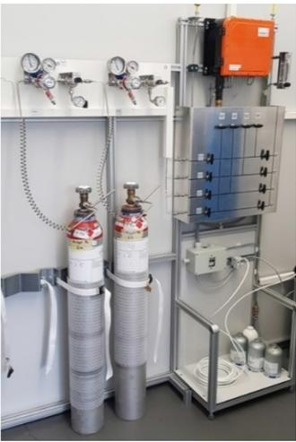
Für H<sub>2</sub> entwickeltes Mikro-GC-System.
